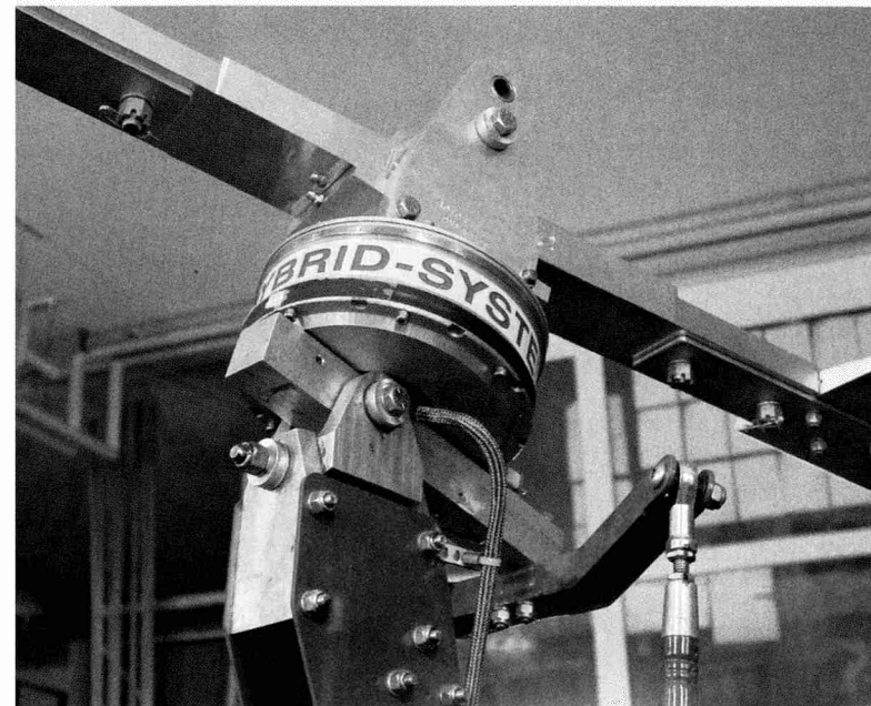
SO FUNKTIONIERT'S: Ein Elektromotor bringt den Rotor vor dem Start auf Touren.
